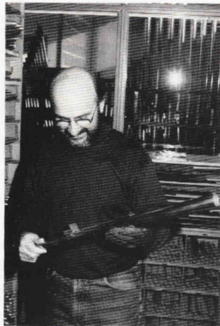
Der Intonateur Oswald Wagner bei der Vorintonation der Pfeifen.
